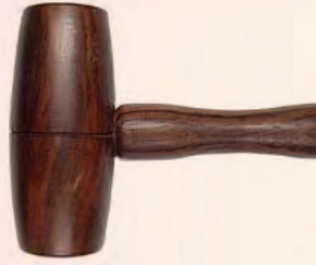
الشكل ( ١٤١ ) : مطارق متنوعة ومتعددة ذات رؤوس خشبية مناسبة للحفر.
