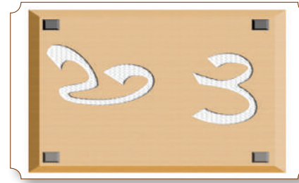
الشكل (١٣٢) تثبيت قطع مربعة من المطاط على أركان قطعة الخشب.
